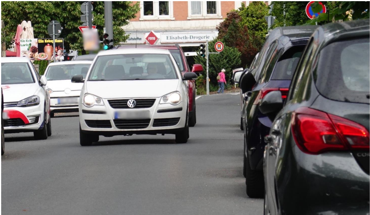
Der verbleibende Straßenraum zwischen parkenden Fahrzeugen beträgt nur ca. 3 m.
