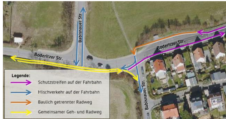
Kreuzungssituation Babnisnauer/Boderitzer Straße mit neuem Zweirichtungsradweg (siehe auch Maßnahme 32)
