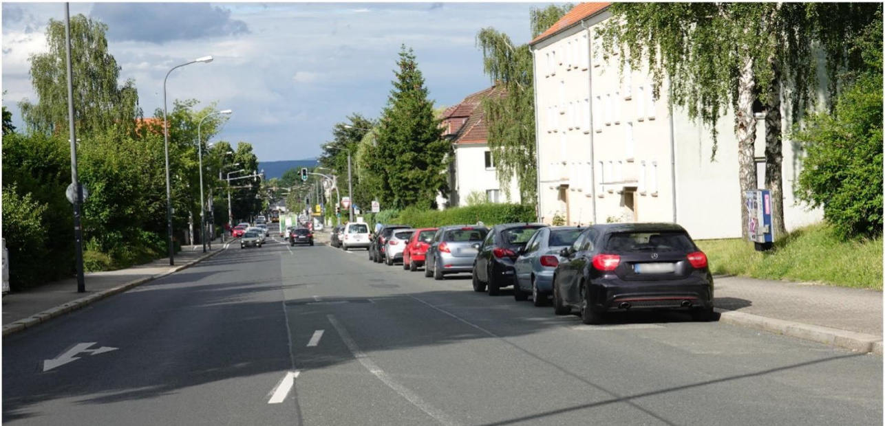
Parkplätze auf der Ostseite der Karlsruher Straße sind auf die Westseite zu verlegen, damit talwärts Radelnde mit hohen Geschwindigkeiten von der Dooring-Gefahr verschont bleiben.
