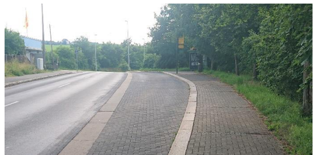
Genau wie an den anderen Haltestellen kann auch hier auf eine separate Busbucht verzichtet werden. Das Wartehäuschen rückt nach links, der Radweg kann dahinter vorbei geführt werden.
